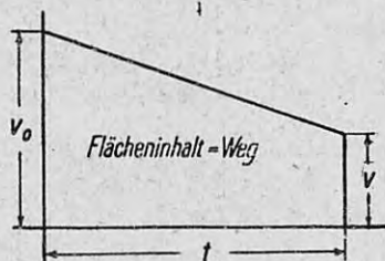
Abb. 6. Geschwindigkeitsabnahme als Funktion der Zeit für eine gleichförmig verzögerte Bewegung.
