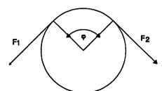
$$\alpha = 2\pi \cdot \frac{\varphi^0}{360^0} \text{ l'arc de "resserrement",}$$
