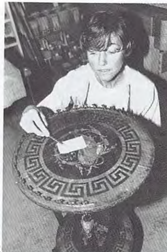
Contern. Abb. 1 bis 4. Kunstatelier Frère: Mit großen Tischlerzwingen werden die einzelnen Stücke eingespannt (1); fehlende Intarsientelle werden auf ein Blatt Papier abgepaust, auf ein Furnierblatt übertragen und dann ausgeschnitten (2); die ergänzten und eingelegten Intarsien werden so poliert, daß niemand mehr die Stellen erkennen kann (3); ein besonders wertvolles und seltenes Stück ist restauriert: es handelt sich um einen Teller der englisch-ostindischen Kompanie mit luxemburgischem Wappen (4). Abb. 5 – Die gevierteilte, von der Gluthitze stark beschädigte Tak zeigt einmal das Wappen der Abtei Echternach (links: Schwurhand auf Kreuz), und das Wappen des Abtes Gregor Schouppe (rechts: Storch mit Schlange).
