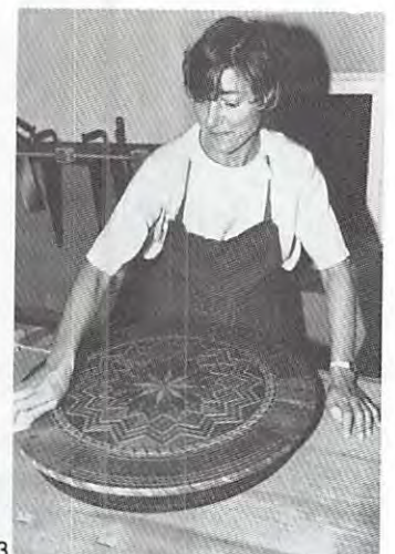
Contern. Abb. 1 bis 4. Kunstatelier Frère: Mit großen Tischlerzwingen werden die einzelnen Stücke eingespannt (1); fehlende Intarsientelle werden auf ein Blatt Papier abgepaust, auf ein Furnierblatt übertragen und dann ausgeschnitten (2); die ergänzten und eingelegten Intarsien werden so poliert, daß niemand mehr die Stellen erkennen kann (3); ein besonders wertvolles und seltenes Stück ist restauriert: es handelt sich um einen Teller der englisch-ostindischen Kompanie mit luxemburgischem Wappen (4). Abb. 5 – Die gevierteilte, von der Gluthitze stark beschädigte Tak zeigt einmal das Wappen der Abtei Echternach (links: Schwurhand auf Kreuz), und das Wappen des Abtes Gregor Schouppe (rechts: Storch mit Schlange).
