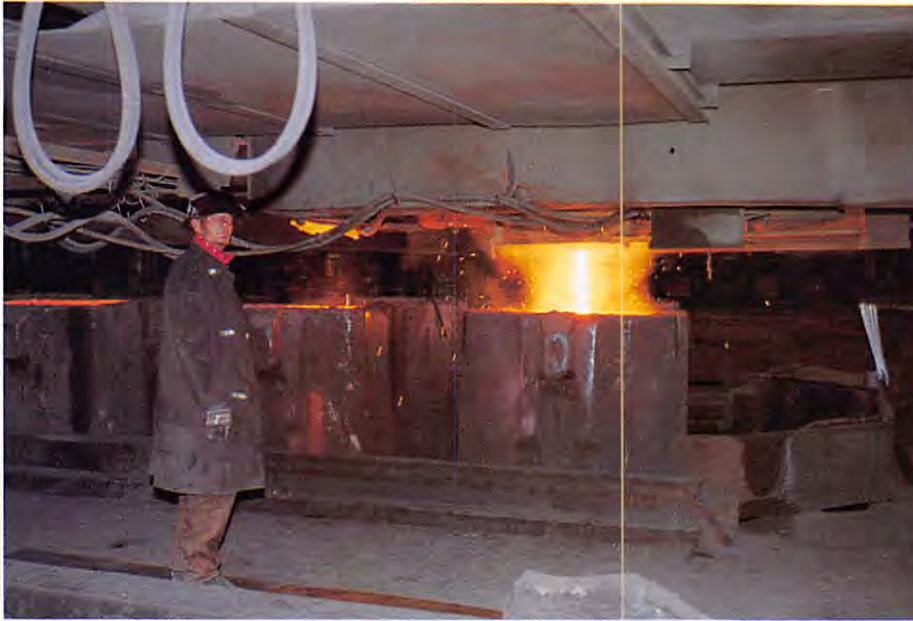
Differdingen, Hüttenwerk. 1: Beim Gießen der Rohblöcke. 2: Grey-Fertigstraße mit Steuerbühne (Zwischen- und Poliergerüst).
