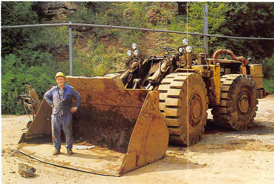
Thillenberg, Differdingen. 1: Diese mächtigen Arbeitsmaschinen, deren Schaufeln 10 Tonnen Gestein fassen, arbeiteten im Innern des Berges. Deshalb mußten für diese Maschinen die Zufahrtsstollen erhöht und verbreitert werden. 2: Mit der beweglichen Kanzel dieser polyvalenten Maschine gelangte der Bergmann bis unter die Stollendecke. 3: Wagenkolonnen rollten bis in die Tiefe des Berges zum Abtransport der Erzmassen. 4: Kilometerlange Gänge führten in den Berg bis zu den Arbeitsstellen. Die viereckigen Platten an den Decken, mit Bolzen im Gestein verankert, sollten loses Gestein festhalten. 5: Unter ohrenbetäubendem Getöse brachte die Lademaschine das Gestein zur Wagenkolonne.
