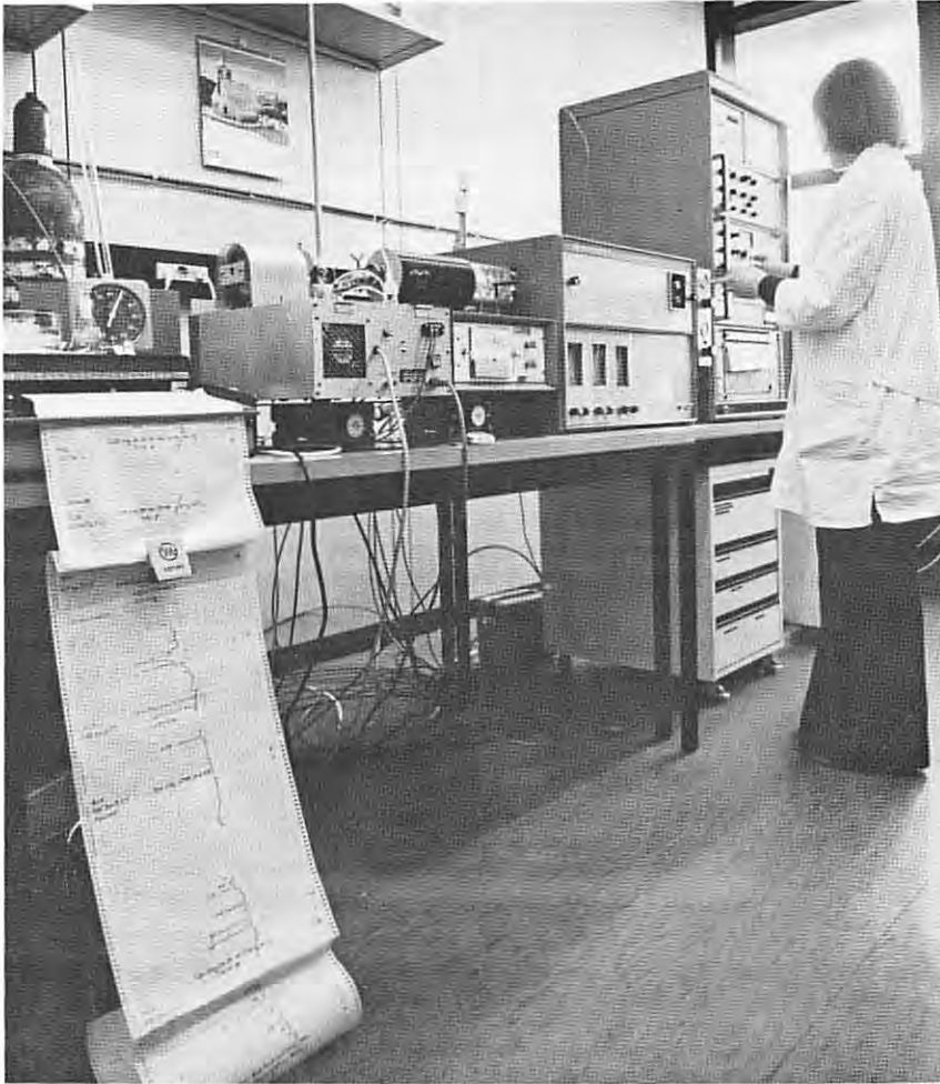
Im Krebsforschungszentrum in Heidelberg: Gas-Chromatographie zum Nachweis von Spuren krebserzeugender Verbindungen in Umwelt-Medien.
