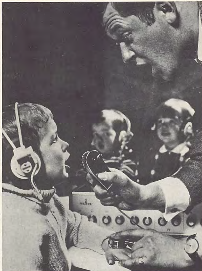
Sprache erfühlen können taubstumme oder taubblinde Kinder mit diesem Siemens-Gerät. Der Vibrator (unten) wird dabei direkt auf das Handgelenk, Brustbein, Schlüsselbein oder auf die oberen Halswirbelknochen aufgelegt. Mit ihm können die Kinder die Töne, die gleichzeitig aus dem Kopfhörer kommen, erfühlen
