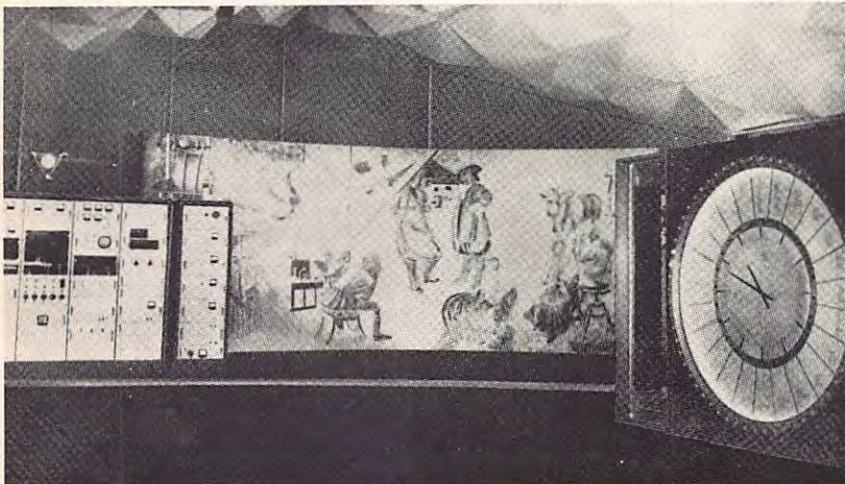
Auf der Brüsseler Weltausstellung 1958 war im Schweizer Pavillon eine Atomuhranlage montiert. Links im Bild befindet sich das Atomuhrwerk mit Quarzuhr, rechts das Zifferblatt der Mutteruhr, die zugleich eine polytropische Uhr darstellt
